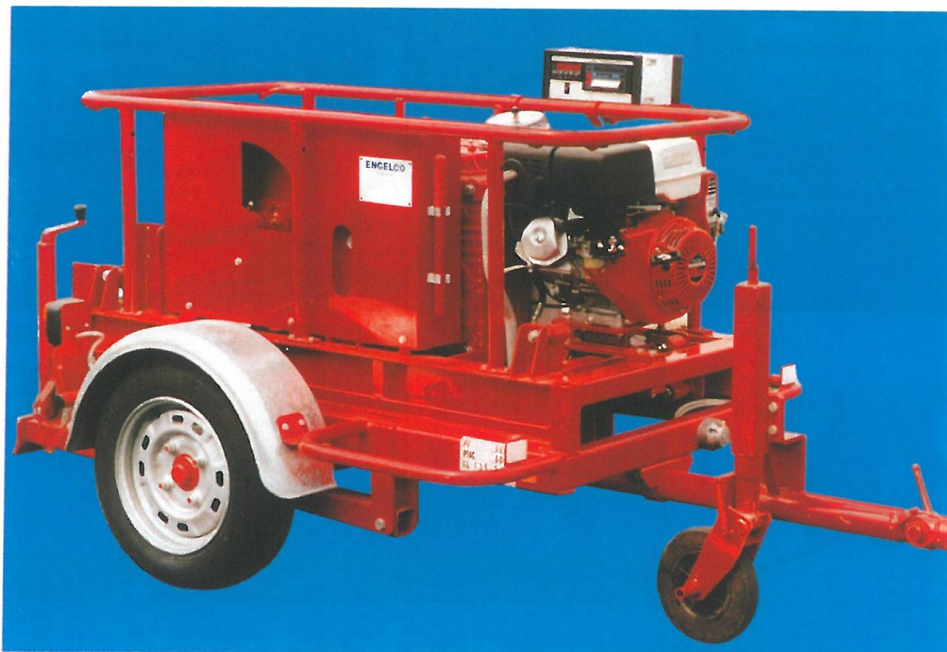
Ce treuil a été spécialement conçu pour la pose des câbles électriques, téléphoniques et des tuyaux polyéthylène. Il peut être utilisé par **un personnel non qualifié**, sans aucun danger.
