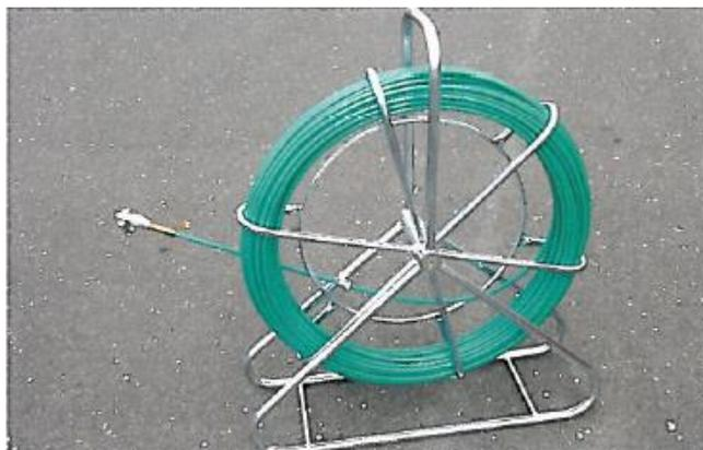
**Aiguille fibre de verre sur dévidoir à roulettes**
