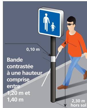
Même avec des contraintes architecturales ou avec des exigences d'ordre esthétique de la part du maître d'ouvrage (charte existante), la réglementation permet de travailler sur le contraste d'une partie seulement du panneau par rapport à une autre (à son support par exemple).
