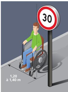
Pour les PMR, la largeur minimale du cheminement doit être de 1,40 m libre de mobilier ou de tout autre obstacle éventuel. Une réduction à 1,20 m étant acceptée en l'absence de mur ou d'obstacle de part et d'autre du cheminement.
